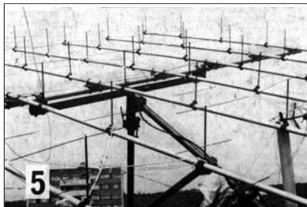
Sl. 71. Kolinearni antenski sistem za 432MHz sa kojim je ekipa YU1AW uradila prve EME veze u SFRJ
