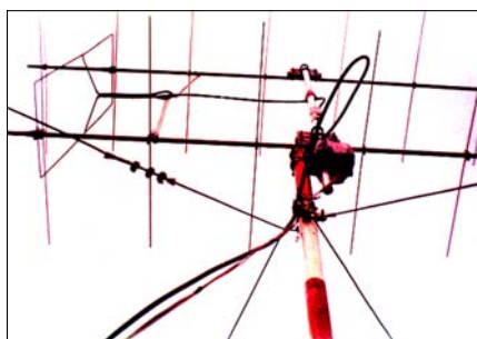
Sl. 76a Pogled sa strane na novu SLOT antenu "9+9" koju je konstruisao YU1MS (1980)
